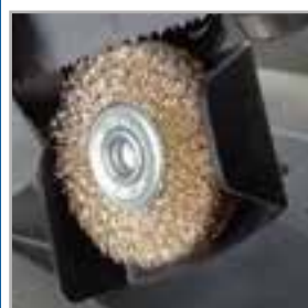
Guidalama posteriore con spazzola per pulitura della lama
