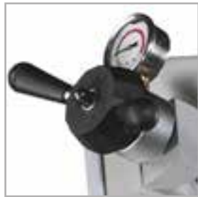
Volantino per un facile tensionamento lama e manometro indicatore della tensione
